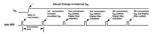
FIGURE 29. SDO/RDY DELAY AFTER MULTIPLEXER CHANGE
