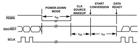
FIGURE 37. POWER-DOWN MODE WAVEFORMS
