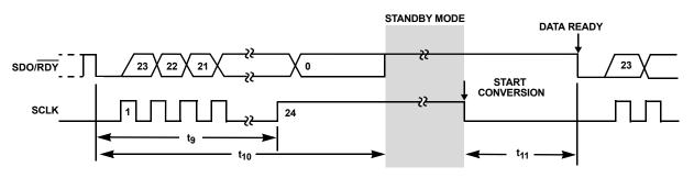
FIGURE 33. STANDBY MODE WAVEFORMS
