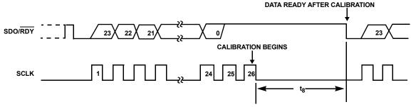
FIGURE 32. OFFSET CALIBRATION WAVEFORMS
