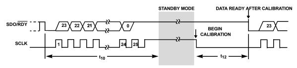
FIGURE 34. OFFSET CALIBRATION WAVEFORMS AFTER STANDBY
