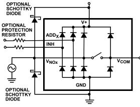
FIGURE 8. OVERVOLTAGE PROTECTION
