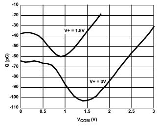
FIGURE 14. CHARGE INJECTION vs SWITCH VOLTAGE
