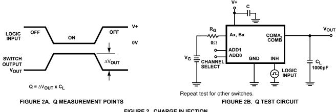
**FIGURE 2. CHARGE INJECTION**
