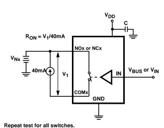
FIGURE 3. R<sub>ON</sub> TEST CIRCUIT
