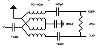
FIGURE 31. RECOMMENDED CLOCK DRIVE
