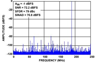
FIGURE 14. SINGLE-TONE SPECTRUM AT 190MHz
