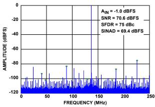
FIGURE 15. SINGLE-TONE SPECTRUM AT 363MHz
