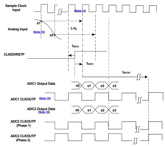
FIGURE 35. SYNCHRONOUS RESET OPERATION
