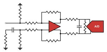
**FIGURE 30. DIFFERENTIAL AMPLIFIER INPUT**
