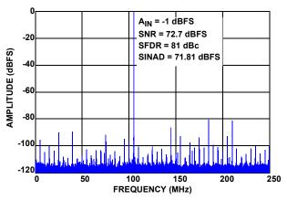
FIGURE 13. SINGLE-TONE SPECTRUM AT 105MHz
