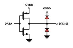
FIGURE 48. CMOS OUTPUTS
