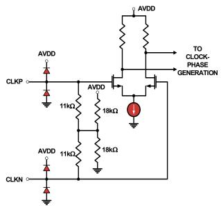
FIGURE 44. CLOCK INPUTS
