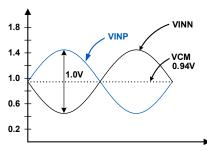
FIGURE 27. ANALOG INPUT RANGE
