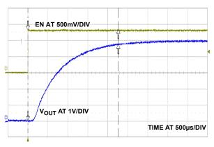
FIGURE 8. START-UP WAVEFORM
