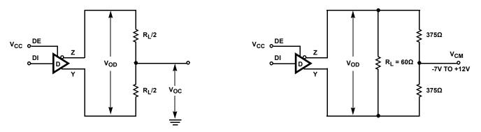
FIGURE 1A. V<sub>OD</sub> AND V<sub>OC</sub>
