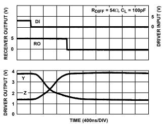
FIGURE 15. DRIVER AND RECEIVER WAVEFORMS, HIGH TO LOW (ISL8488E/ISL8489E)
