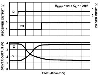
FIGURE 14. DRIVER AND RECEIVER WAVEFORMS, LOW TO HIGH (ISL8488E/ISL8489E)
