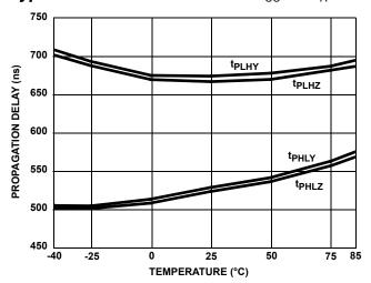
FIGURE 10. DRIVER PROPAGATION DELAY vs TEMPERATURE (ISL8488E/ISL8489E)
