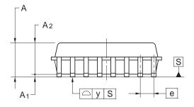
Dimension in Millimeters Referance Symbol Nom Max Min D 4.85 5.00 5.15 5.20 D<sub>1</sub> 5.05 5.35 Е 4.40 4.20 4.60  $A_2$ 1.50 0.075 0.125 0.175 Α 1.725 0.17 0.32  $b_{\text{p}}$ 0.24  $b_1$ 0.22 0.20 С 0.17 0.14  $c_1$ 0.15 8° 0°  $\mathsf{H}_\mathsf{E}$ 6.40 6.20 6.60 е 0.65 Х 0.13 0.10  $Z_D$ 0.225 L 0.50 0.65 0.35 1.00  $L_{1}$
