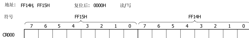
图 6-3. 16 位定时器捕捉/比较寄存器 000 (CR000)的格式
