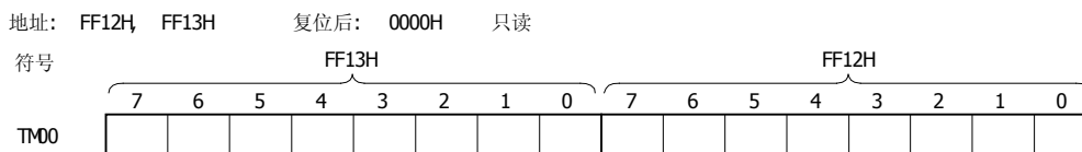
图 6-2. 16 位定时器计数器 00 (TM00)的格式
