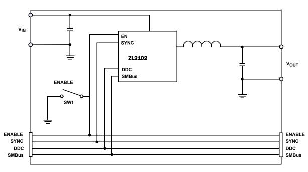
FIGURE 1. ZL2102DEM01Z BLOCK DIAGRAM
