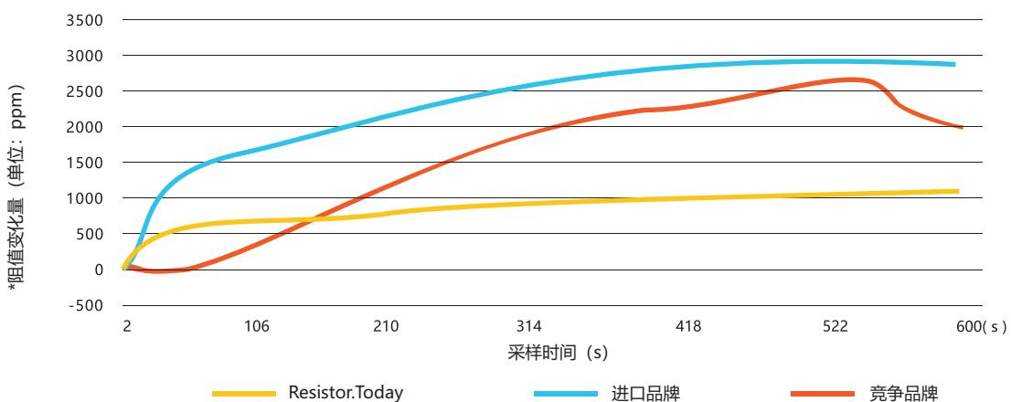
\*阻值变化量：按照  $(Rt-Ro)/Ro \times 1000000$  计算而来，Rt是当前时刻所测的阻值，Ro是通电瞬间所测得的阻值大小。
