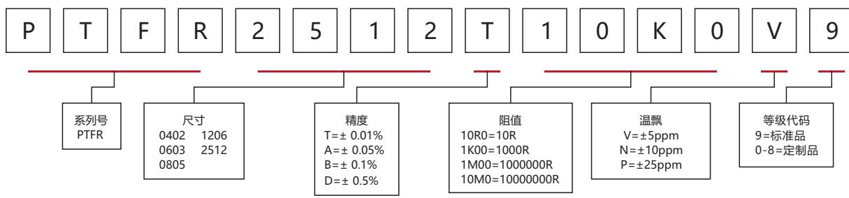
A, 更高或者更低的阻值，更高的精度，更高的功率，更低的温飘，更大的尺寸请联系我们确认；
