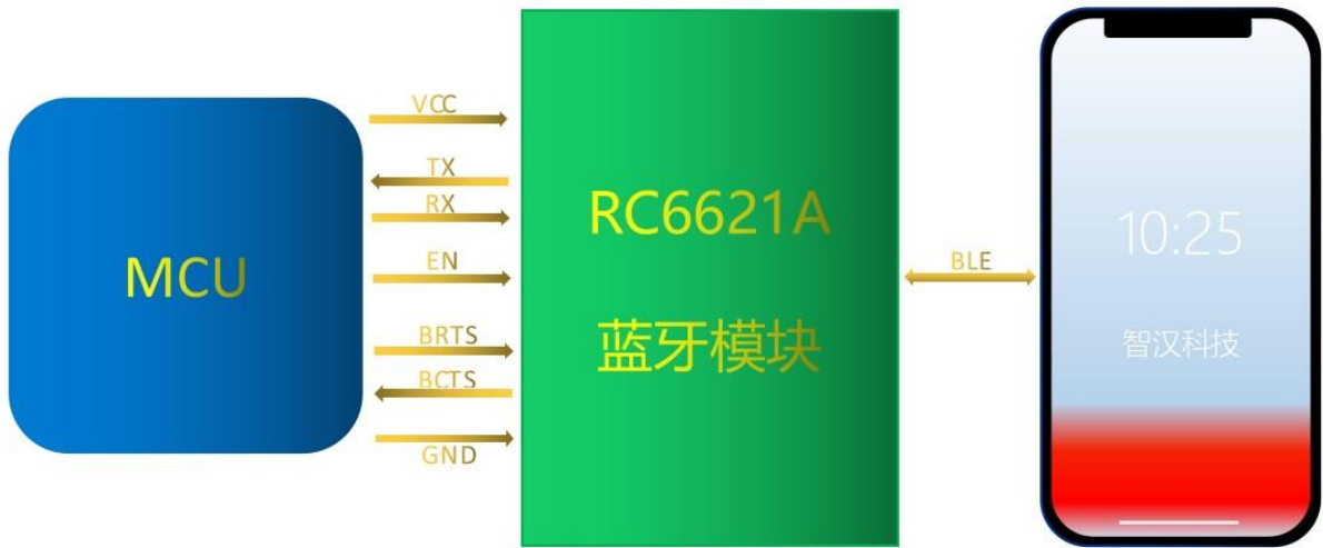
图1 模块桥接模式示意图
