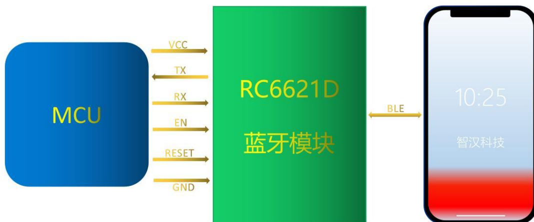
图1 模块桥接模式示意图
