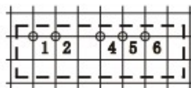
俯视图,栅格间距 2.54mm 开孔直径 1.00mm
