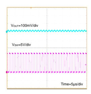
Figure 90. Vout Ripple Iout=8A (V<sub>IN</sub>=12V, V<sub>OUT</sub>=5V, FREQ=H(600kHz))
