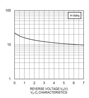
CAPACITANCE BETWEEN TERMINALS:C<sub>t</sub>(pF)
