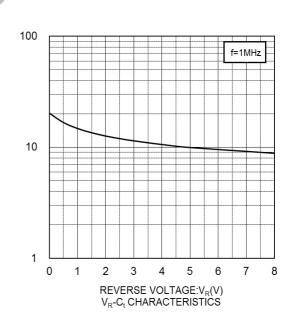
CAPACITANCE BETWEEN TERMINALS:C<sub>t</sub>(pF)
