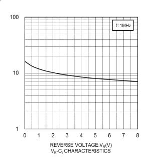
CAPACITANCE BETWEEN TERMINALS:C<sub>t</sub>(pF)
