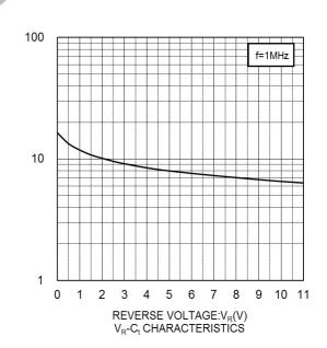
CAPACITANCE BETWEEN TERMINALS:C<sub>t</sub>(pF)
