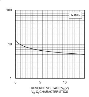
CAPACITANCE BETWEEN TERMINALS:C<sub>t</sub>(pF)
