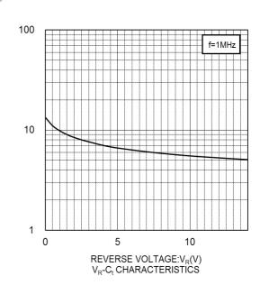
CAPACITANCE BETWEEN TERMINALS:C<sub>t</sub>(pF)
