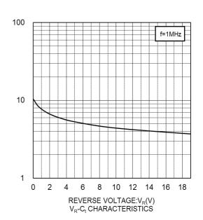
CAPACITANCE BETWEEN TERMINALS:C<sub>t</sub>(pF)
