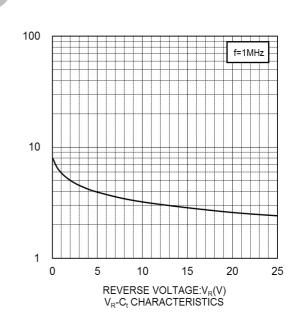
CAPACITANCE BETWEEN TERMINALS:C<sub>t</sub>(pF)
