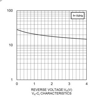
CAPACITANCE BETWEEN TERMINALS:C<sub>(</sub>(pF)
