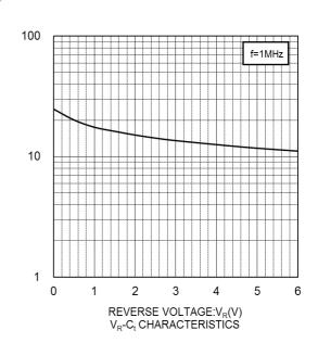
CAPACITANCE BETWEEN TERMINALS:C<sub>t</sub>(pF)
