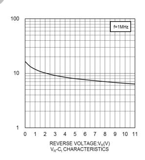
CAPACITANCE BETWEEN TERMINALS:C<sub>t</sub>(pF)
