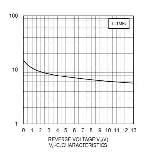
CAPACITANCE BETWEEN TERMINALS:C<sub>t</sub>(pF)
