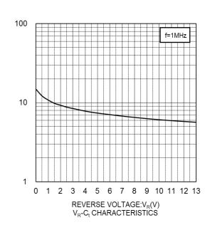
CAPACITANCE BETWEEN TERMINALS:C<sub>t</sub>(pF)
