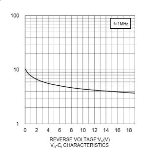
CAPACITANCE BETWEEN TERMINALS:C<sub>t</sub>(pF)
