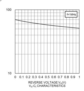
CAPACITANCE BETWEEN TERMINALS:C<sub>(</sub>(pF)
