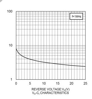
CAPACITANCE BETWEEN TERMINALS:C<sub>t</sub>(pF)
