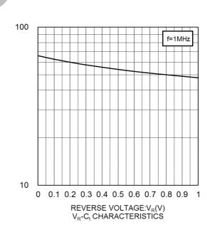
CAPACITANCE BETWEEN TERMINALS:C<sub>(</sub>(pF)
