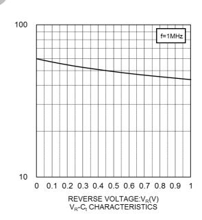
CAPACITANCE BETWEEN TERMINALS:C<sub>(</sub>(pF)
