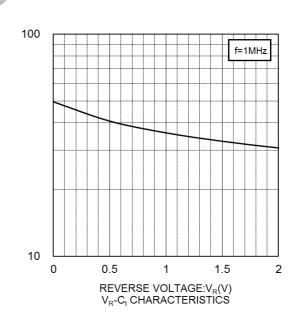
CAPACITANCE BETWEEN TERMINALS:C<sub>i</sub>(pF)
