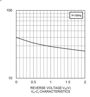
CAPACITANCE BETWEEN TERMINALS:C<sub>f</sub>(pF)
