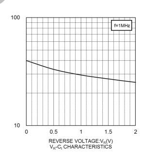
CAPACITANCE BETWEEN TERMINALS:C<sub>f</sub>(pF)
