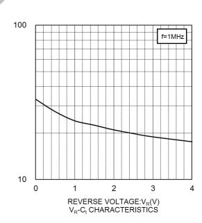
CAPACITANCE BETWEEN TERMINALS:C<sub>f</sub>(pF)
