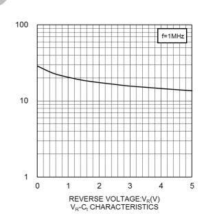
CAPACITANCE BETWEEN TERMINALS:C<sub>(</sub>(pF)
