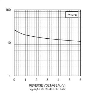
CAPACITANCE BETWEEN TERMINALS:C<sub>t</sub>(pF)
