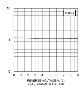
CAPACITANCE BETWEEN TERMINALS:C<sub>i</sub>(pF)
