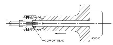
5. REMOVE CONNECTOR FROM SUHNER BASE TOOL AND INSTALL DIELECTRIC SUPPORT BEAD USING PCI TOOL SET 450040 F:\DWG\MISC\Mktg\PRF92-P-C-EE-405-SD-X-MKT.SLDDRW
