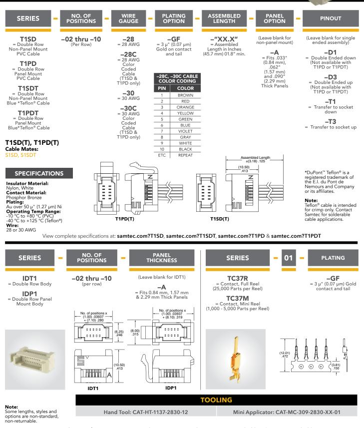
View complete specifications at: samtec.com?IDT1, samtec.com?IDP1, samtec.com?TC37R & samtec.com?TC37M
