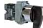
长手柄 2或3位置, 保持或自 动回中心位 XB2BJ●●C , 带1常开 或2常开或1常闭触点 第7页
