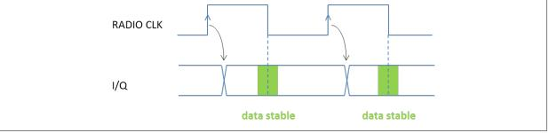
Figure 4: I/Q on Clock Rising Edge
