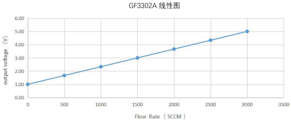
图 3. 模拟输出特性曲线（供电电压 12V）
