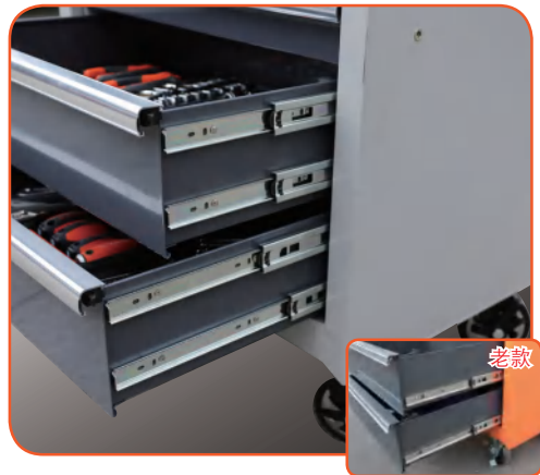
导轨和轨道，由原卡点安装升级为铆接安装，抽屉固定更加牢固、顺滑；6、7、8抽工具车，底层的抽屉升级为双导轨，承重能力提升50%以上；
