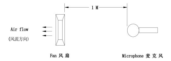
(在背景噪音不超过 18dB(A)的无响室内,将待测风扇通入额定的工作电压,悬掉入空中,将麦克风放于风扇同一平面且离待测风扇进风口一米处进行测试其 B&K 值)
