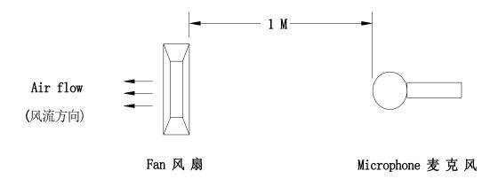
(在背景噪音不超过 18dB (A) 的无响室内,将待测风扇通入额定的工作电压,悬掉入空中,将麦克风放于风扇同一平面且离待测风扇进风口一米处进行测试其 B&K 值)
