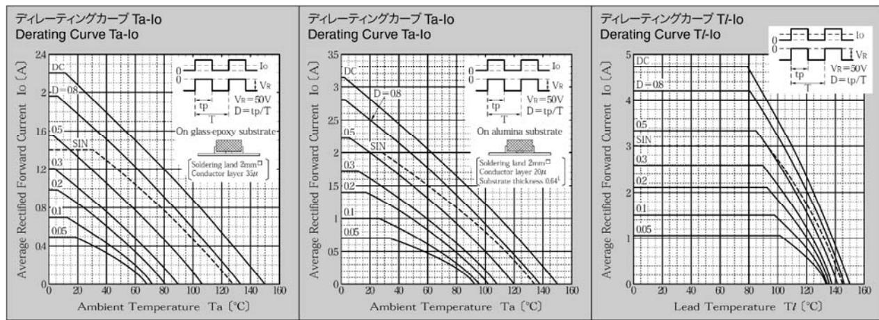
\* Sine waveは50Hzで測定しています。
